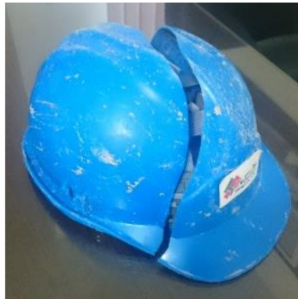
برخورد سر کارگر به یک تیر بتنی در کارگاه اهواز
