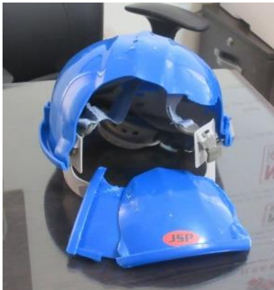
سقوط سر جک از ارتفاع ۵ متری ۰۶/۰۸/۹۴ ساعات اولیه کار آقای حسین حاجی پور دوست آرمانتور بند کارگاه اهواز
